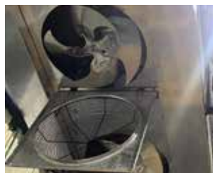
Paneles Venturi para ventilador abatibles para servicio
