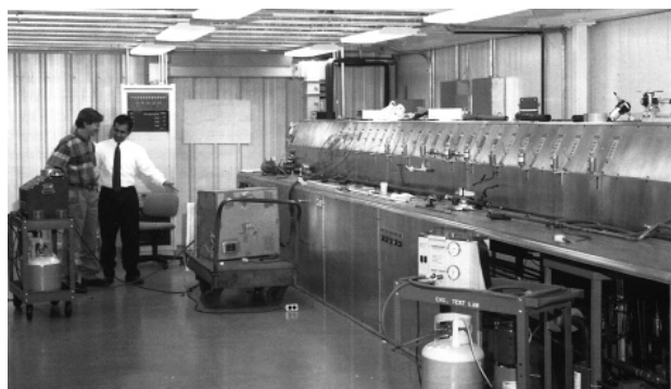
Área de Prueba de Refrigerante en dos Fases del Laboratorio Heatcraft-Frigus Bohn, con termopares y transductores de presión. El laboratorio con PC y otros equipos de prueba también están en esta área.
