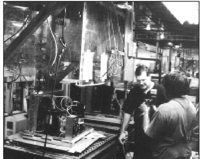
Una unidad condensadora sometida a prueba de fuga.
